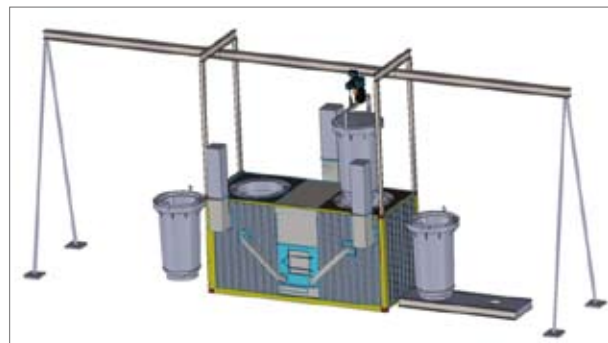
Figuur 1 Schematische weergave van de MF 2014 houtskoolinstallatie.
