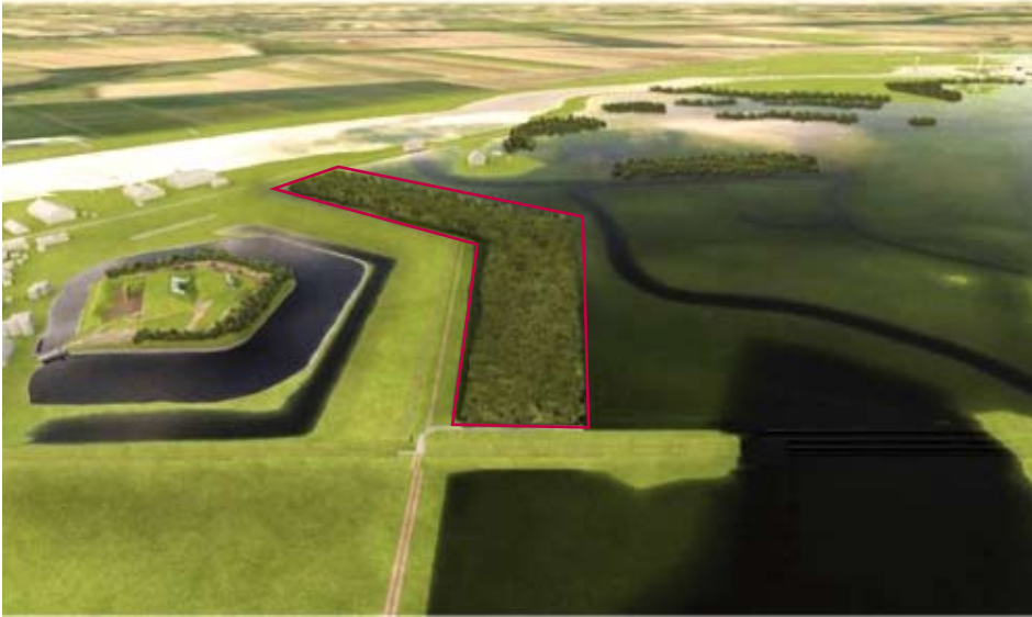
Artist impression van het golfvremdende griend (rood omlind vlak) bij Fort Steurgat (bron: www.deltaexpertise.nl )
