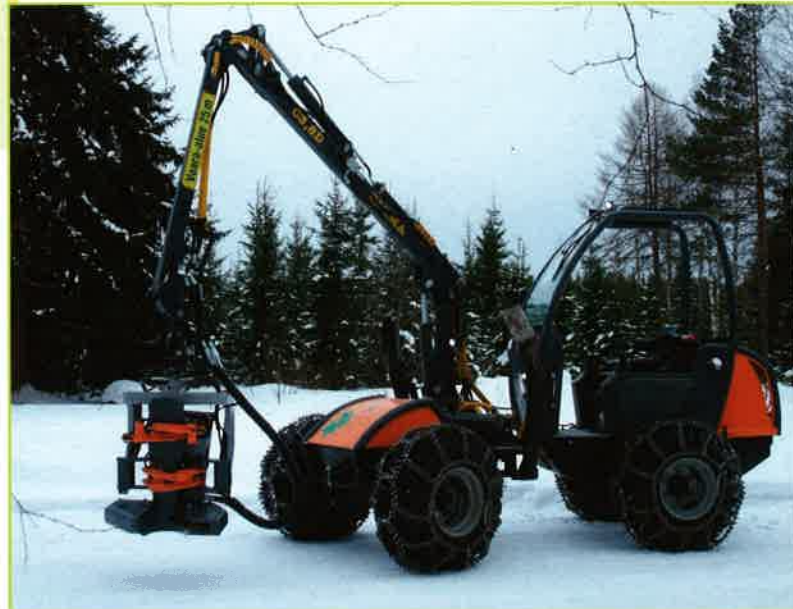
Het Finse Usewood heeft de Eco Small Harvester in zijn pakket zitten. Met een gewicht van 1.700 kilogram, een breedte van 1,5 meter en een kraancapaciteit van 350 kilogram is het een interessante machine voor dunningen in jonge opstanden. © Usewood Oy
