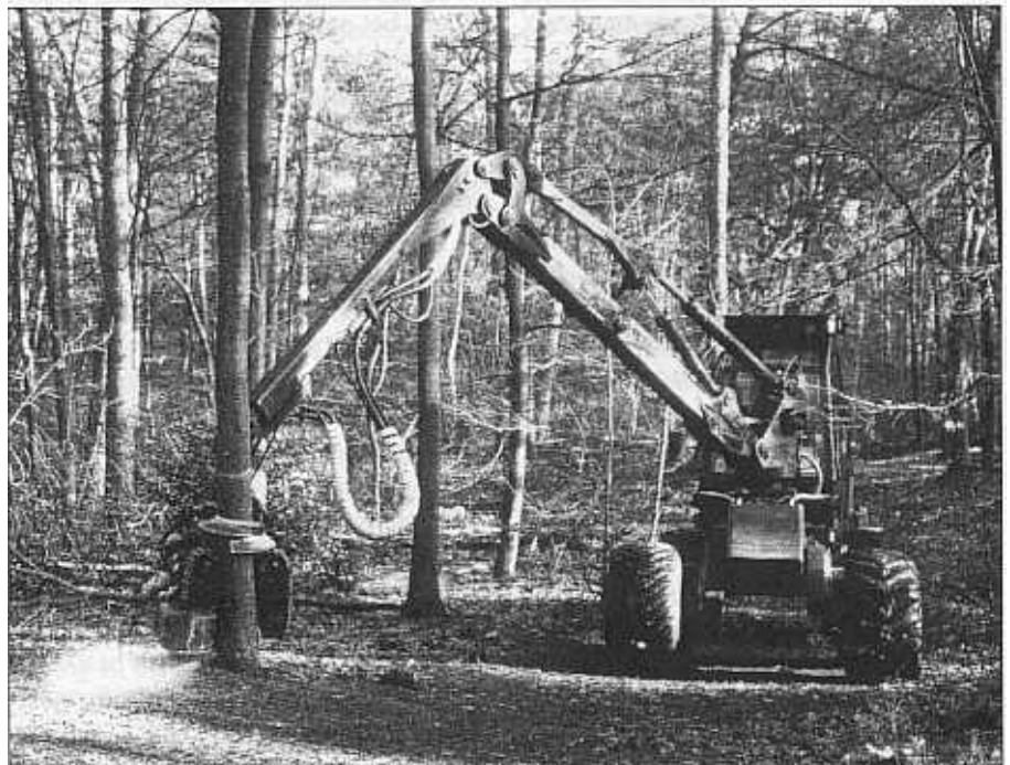
Ook in de bosbouw werkt men met moderne machines, zoals hier met de processor
