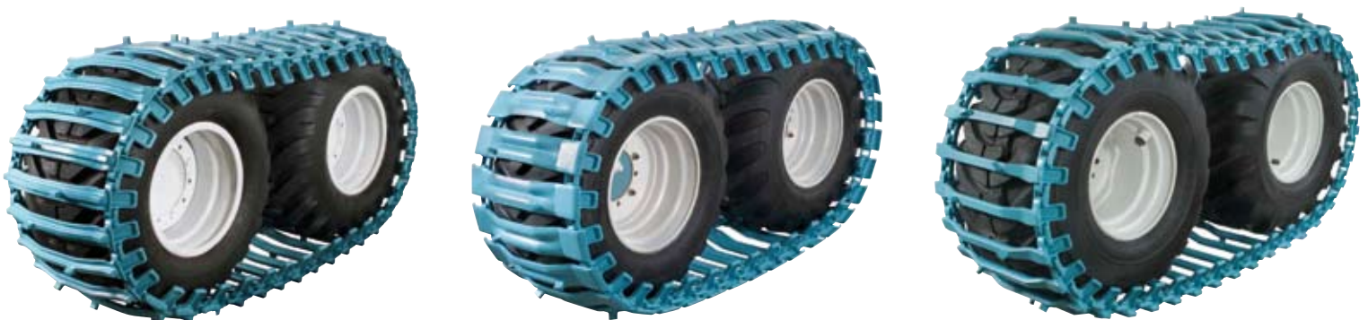
De tracks van Olofsfors: de 'gewone' tracks, tracks voor kwetsbare en drassige bodems en het type voor steil terrein.
