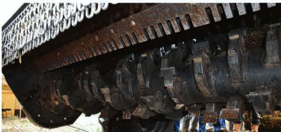
De rooibreedte is 2,5 m en de bek heeft 50 tanden die het materiaal verpulvert.
