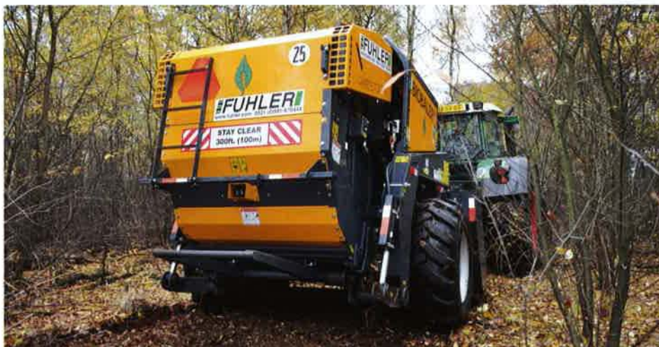
Onder gunstige werkomstandigheden is de biobaler in staat om 0,4 ha biomassa per uur te verwerken.
