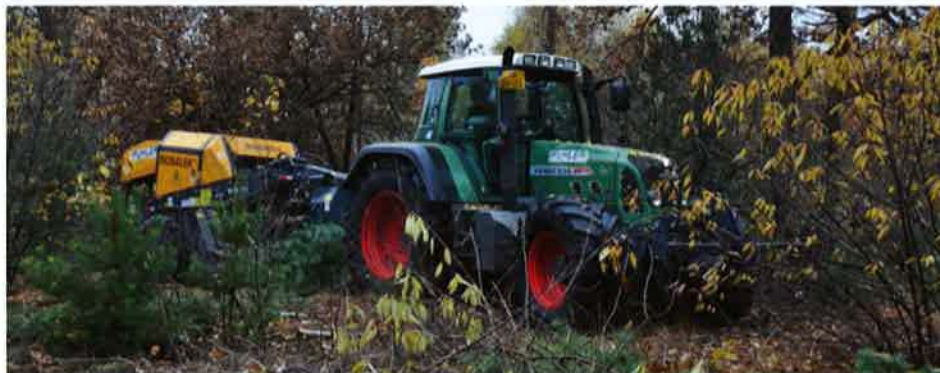
Een tractor met een minimaal motorvermogen van 200 pk is nodig voor de mechanische aandrijving van de Biobaler.
