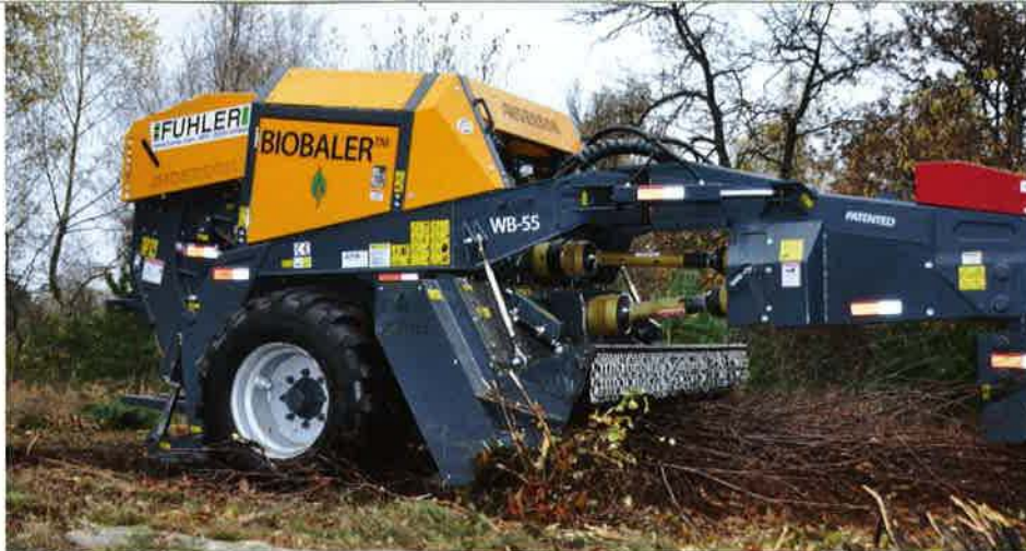
Het voordeel van werken met de Biobaler is dat slechts één medewerker in één werkgang struiken e.d. kan verwerken in een compacte ronde baal.
