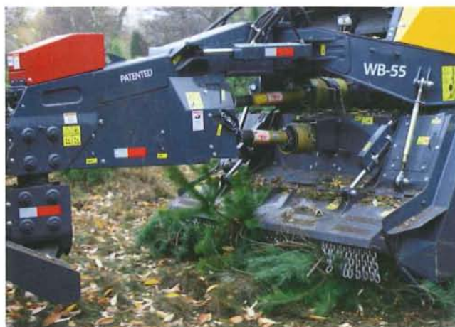
◀ Deze Biobaler is uitgerust met de korte dissel die een knikfunctie heeft. In combinatie met een aslift van dertig centimeter kun je ongelijk terrein goed nemen en stobben ontwijken. Rotor en pers worden apart aangedreven.
