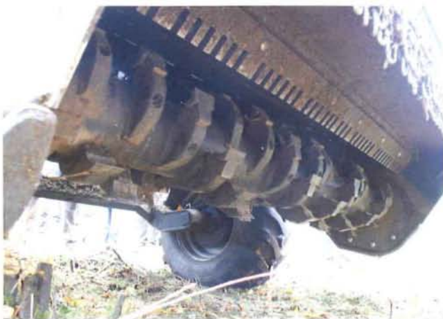
◀ Deze freesrotor in de pickup vreet de houtbestanden kaal en versnipperd ze ten dele en snijdt de stam af. Het langere hout gaat deels over de freesas via een extra doorvoerklepelas de pers in.
