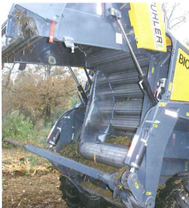
◀ De perskamer heeft de bekende persrollen en een elevatorketting in de achterklep. Voor het afleggen is een eenvoudige aflegger gemonteerd.
