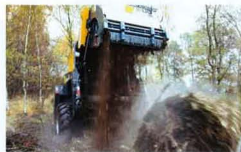
De balen worden warm door het draaien van de baal tegen de zijwanden van de pers. Ze wegen tussen 500 en 600 kg.
