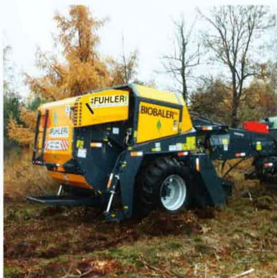
Acht rollen en kettingen met dwarsstaven in de achterklep geven de balen vorm. De invoerrotor is nog net te zien boven de onderste rol.
