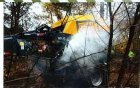
De riemen die de mulcher aandrijven stonden te slap, waardoor ze te snel slipten. Een enorme rookontwikkeling was het gevolg.
