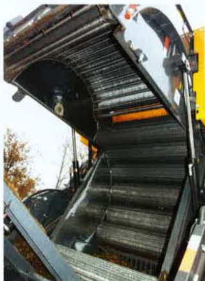
Acht rollen en kettingen met dwarsstaven in de achterklep geven de balen vorm. De invoerrotor is nog net te zien boven de onderste rol.
